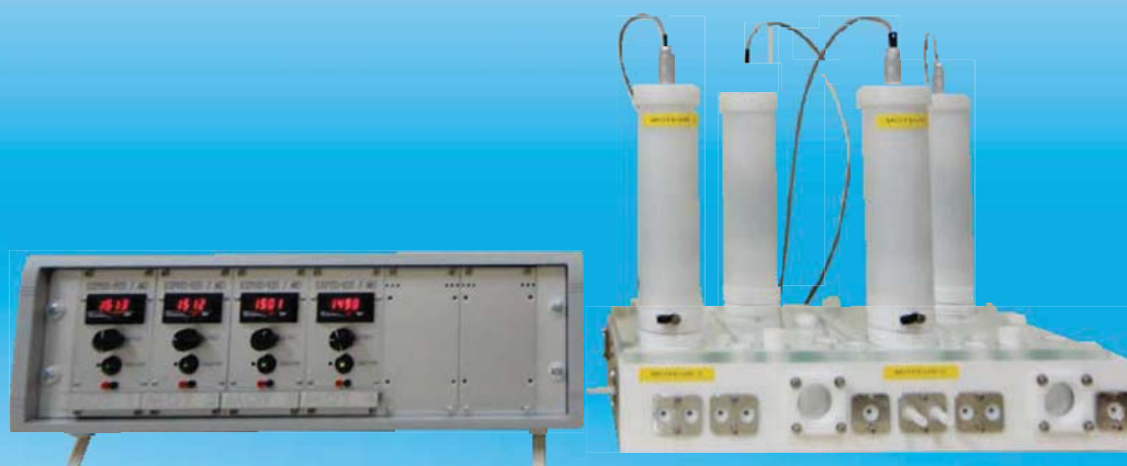
MD UX 1-4 : laboratorní mísič - usazovák, 4 stupňová baterie
