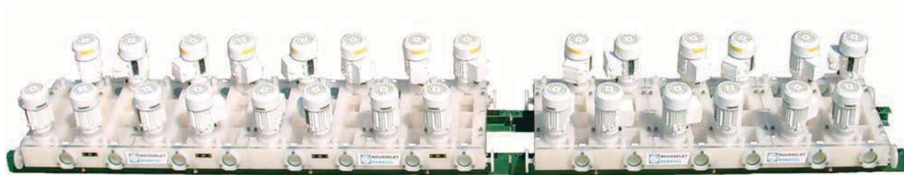
28-stupňová baterie SX 2-0, PVDF konstrukce 6 stupňů: primární extrakce 10 stupňů: stripování 12 stupňů: sekundární extrakce
